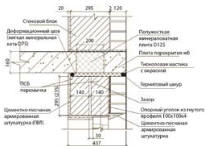
Вертикальный разрез наружной ненесущей стены из полистиролбетонных блоков и перемычек системы «ЮНИКОН»
