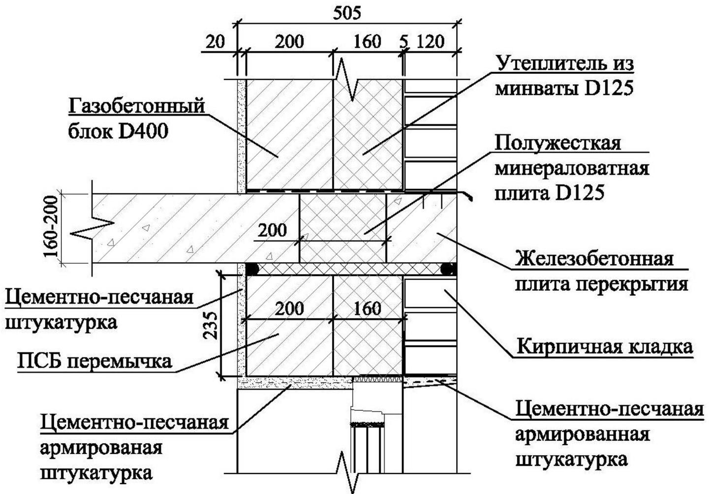
Вариант технического решения применения ПСБ перемычек «ЮНИКОН» в 3х-слойных наружных ненесущих стенах с утеплителем из минваты и газобетонных блоков D400 для зданий с кирпичным фасадом.
