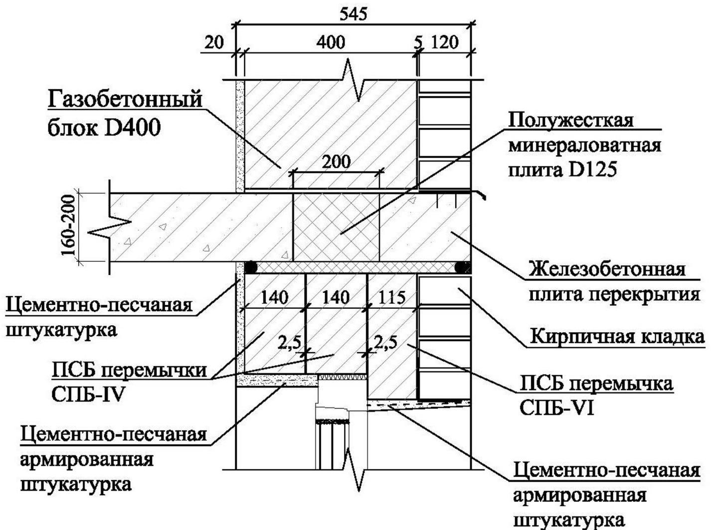
Вариант технического решения применения ПСБ перемычек «ЮНИКОН» в наружных ненесущих стенах из газобетонных блоков D400 для зданий с кирпичным фасадом.
